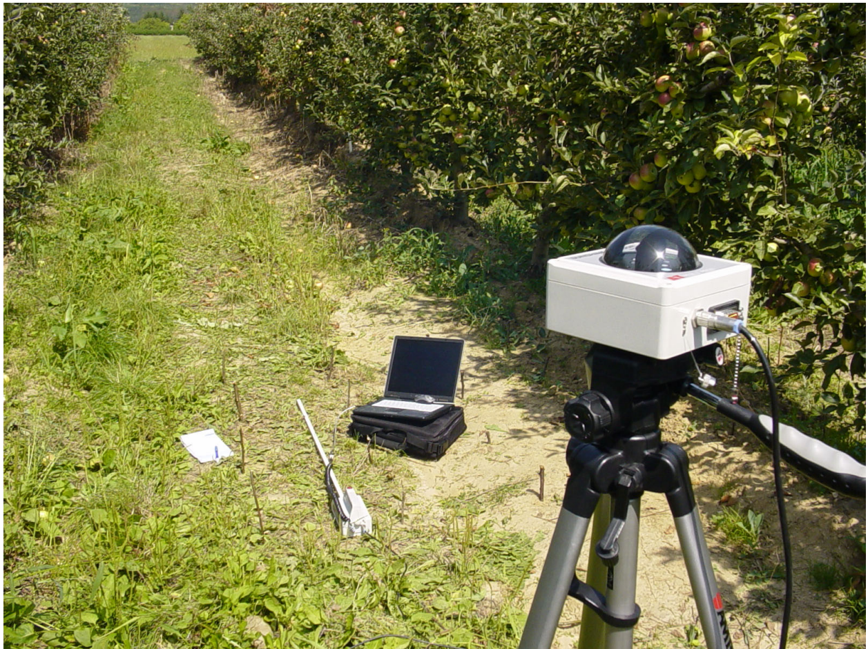
Fig. 1. Vedere de ansamblu a echipamentului SunScan Canopy Analysis System, cu senzorul radiației fotosintetice totale (PAR, dreapta), senzorul de captare a acesteia și laptopul de înregistrare a datelor în câmp, Pitești-Maracineni. Fig. 1. View of the SunScan Canopy Analysis System equipment
